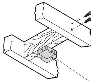
Si el ventilador de techo no hay una caja de montaje listada-UL existente, instala una utilizando las instrucciones siguientes:
