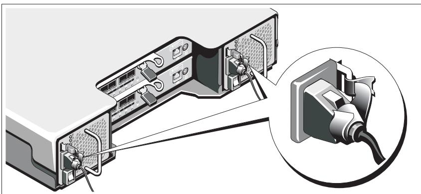
Fixez fermement les câbles au support de fixation à l'aide de la lanière fournie. Branchez ensuite l'autre extrémité des câbles d'alimentation sur une prise de courant mise à la masse ou sur une source d'alimentation autonome (onduleur [UPS] ou unité de distribution de l'alimentation [PDU]...). Chaque bloc d'alimentation doit être connecté à un circuit d'alimentation séparé.
