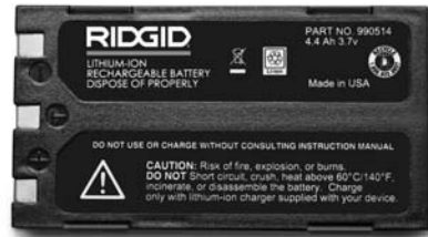
Figura 33 – Etiquetas en el bloque de pilas
