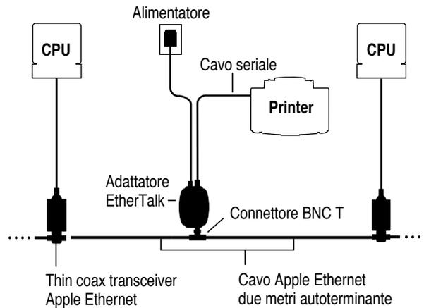
**IMPORTANTE** Se la stampante è l'ultimo dispositivo sulla rete, è necessario collegare una resistenza 50-ohm terminante al connettore BNC T.
