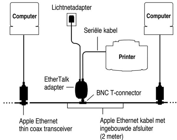
**BELANGRIJK** Als de printer het laatste apparaat in het netwerk is, dient een afsluitweerstand van 50 ohm te worden aangesloten op de BNC T-connector.
