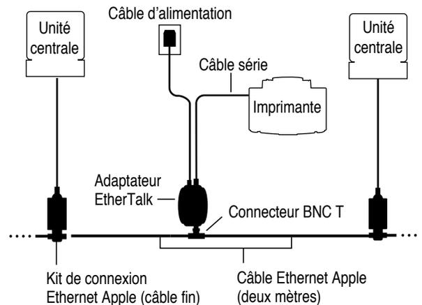
**IMPORTANT** Si l'imprimante est le dernier périphérique du réseau, vous devez connecter une résistance de 50-ohm au connecteur BNC T.
