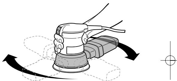
Puede agarrar la herramienta por la parte superior o alrededor de la caja del motor tal como se muestra en la ilustración. La forma contorneada se diseñó con este propósito.
