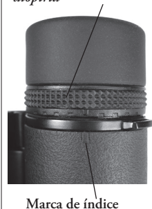
Fig. 2-Anillo de ajuste de dioptría
