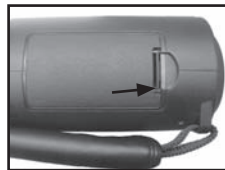
Trinco da tampa do compartimento de pilhas
