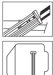
**Nota:** Asegúrese de insertar las cabezas de las puntillas en el área ancha en la parte superior del cargador, con las puntas hacia abajo.
