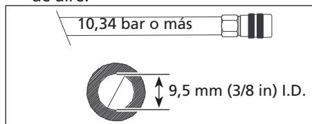
4. Use un regulador de presión (de 0 bar - 8,62 bar) en el compresor. Se necesita un regulador de presión para controlar la presión de operación de la herramienta entre 4,83 bar y 8,27 bar.
