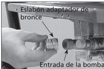
Figura 4 - Conecte el eslabón adaptador a la bomba
